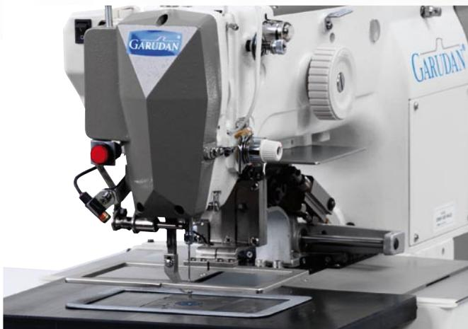
Stroje GPS/G-1507 a GPS/G-2010 jsou standardně dodávány s pneumaticky ovládaným děleným rámečkem a šijí maximální rychlosť 2800 stehů/min. V základním provedení nejsou stroje dodávány s „EH“ – ergonomickým držákem monitoru. Ten je možno objednat.
